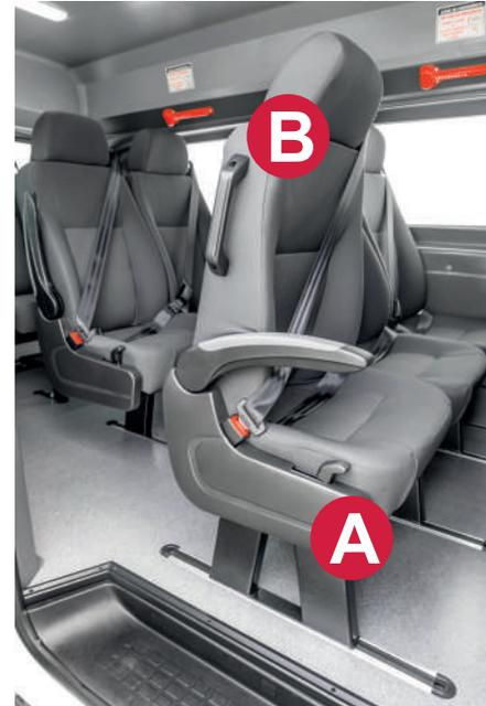
O primeiro assento da 1ª fileira permite uma inclinação de 18° para a frente através da alavanca **A** para aumentar o vão de passagem para a 2ª e 3ª fileiras de assentos. Utilize a alça **B** para auxiliar a inclinação do encosto para a frente.
