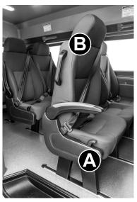
O primeiro assento da 1° fileira permite uma inclinação de 18° para a frente através da alavanca A para aumentar o vão de passagem para a 2° e 3° fileiras de assentos. Utilize a alça B para auxiliar a inclinação do encosto para a frente.
