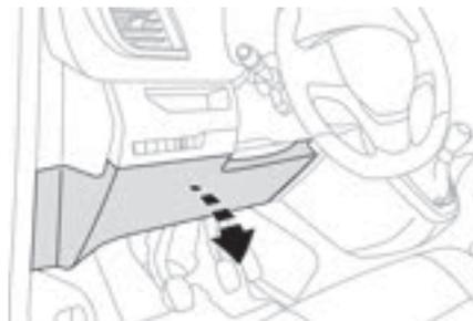
☞ Desencaixe a tampa puxando a parte superior esquerda e, em seguida, a direita.
