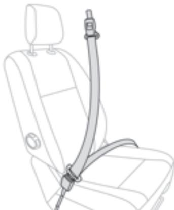
Os cintos de segurança dianteiros encontram-se equipados com um sistema de pré-tensão pirotécnica e limitador de esforço.
