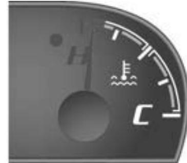
**Se o ponteiro estiver posicionado entre C (frio) e H (quente):** funcionamento normal. Em condições de utilização severas ou condições climáticas quentes, a agulha poderá aproximar-se das zonas de graduação vermelhas.
