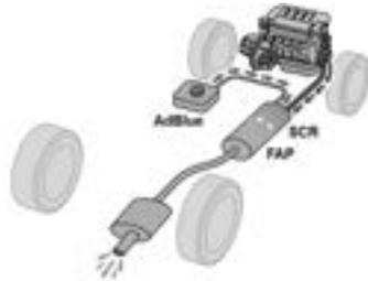
Para respeitar o ambiente e assegurar a conformidade com a norma **Proconve PL7**, sem afetar adversamente o desempenho ou o consumo dos motores a diesel, a CITROËN tomou a decisão de equipar os seus veículos com um sistema que associa o SCR (Redução Catalítica Seletiva) a um filtro de partículas de diesel (FAP) para o tratamento de gases de escape.
