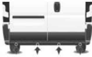
Se estiver instalado no veículo, o sistema é composto por 4 sensores de proximidade instalados no para-choque traseiro.
