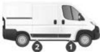
! Tenha atenção para colocar o macaco apenas nas posições 1 ou 2 sob o veículo, garantindo que a cabeça do macaco se encontra centrada sob a zona de apoio do veículo. Caso contrário, o veículo corre o risco de ficar danificado e/ou o macaco de colapsar.
