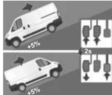
Com o pedal do freio e o pedal da embreagem pressionados, quando soltar o pedal do freio, restam cerca de 2 segundos sem recuo e sem utilizar o freio de estacionamento para efetuar a partida.
