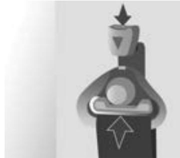
▶ No lado do condutor ou no lado do banco do passageiro lateral, aperte o comando com retorno do cinto e deslize-o por completo e depois libere-o para fixar.
