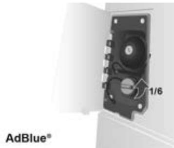
▶ Rode a tampa azul do reservatório de AdBlue® um 6° de volta para a esquerda e retire-o.
