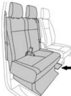
O seu veículo está equipado com extintor de incêndio que está localizado no lado direito da estrutura do banco do motorista. Para soltá-lo rapidamente do suporte, acione sua fixação.
