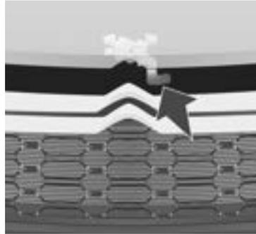
▶ Empurre a alavanca acima da grade para cima e levante o capô.
