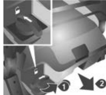
Para retirar a caixa, rode o comando um quarto de volta para desbloquear e depois puxe a caixa para a frente.
