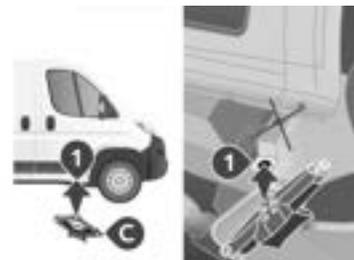
► Posicione o macaco C no ponto de elevação 1 fornecido na parte inferior da carroçaria, perto da roda dianteira.
