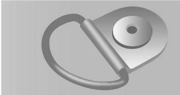
Estão instalados anéis de fixação no piso para fixar e prender cargas: 8 para veículos de comprimento L2; 10 para veículos de comprimento L3.
