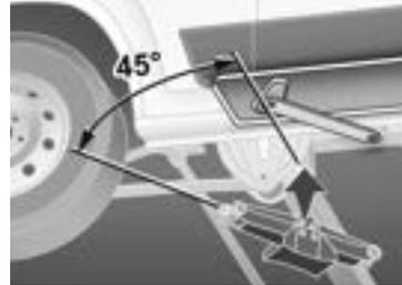
Se o veículo estiver equipado com esta opção, certifique-se de colocar o macaco a um ângulo de **45°** para que não interfira com o apoio para pés.
