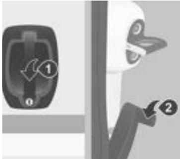
► Puxe o comando na sua direção e depois puxe a alavanca para abrir a porta esquerda. As duas portas abrem a um ângulo de 96°.
