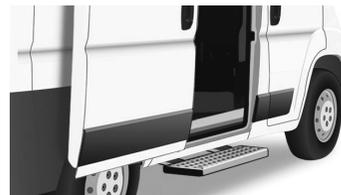
Para facilitar a entrada e saída da área de carga, o veículo pode estar equipado com um estribo, que é rebatido durante a abertura da porta lateral deslizante.
