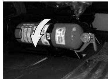
A validade do extintor de incêndio está vinculada ao teste hidroestático (teste para verificação de vazamentos do cilindro), que deve ser feito a cada 5 anos, a partir da data de fabricação gravada no corpo do cilindro.
