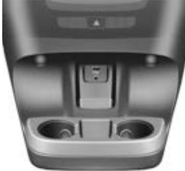
O compartimento de arrumação aberto está situado abaixo do painel da console central. Permite acesso às tomadas auxiliares (tomada jack e USB) concebidas para a transferência de dados para o sistema de áudio.
