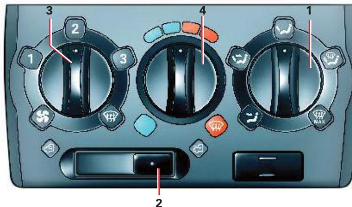
**3- Mando para activar el ventilador****4- Mando para regular la temperatura del aire (mezcla aire caliente/frío).**
