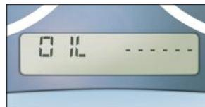
**Un parpadeo de las barras indica un mal funcionamiento del indicador o la falta de aceite.**
