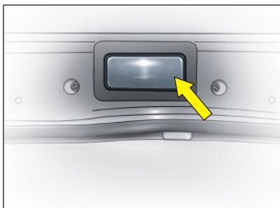
En el compartimento de carga, hay otro plafón situado sobre la puerta trasera. Para encender este plafón presione el lado corto de la pantalla transparente **D**.
