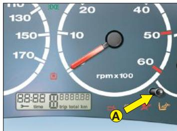
Una presión sobre el botón **A** permite alternar la indicación del cuentakilómetros total con el parcial.
