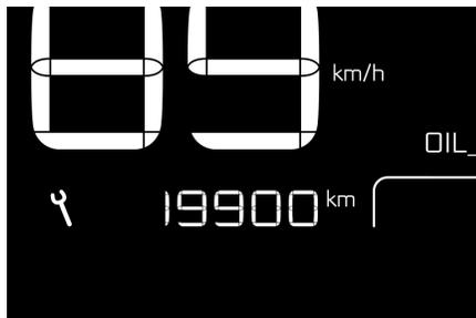
Esta informação é apresentada durante alguns segundos ao ligar a ignição. Informa o motorista sobre o prazo para a próxima revisão a efetuar, de acordo com o plano de manutenção do construtor.
