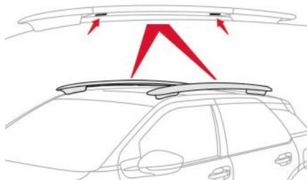
As barras transversais devem ser fixadas nas barras longitudinais, respeitando os pontos de fixação assinalados pelas marcas gravadas nas barras longitudinais.
