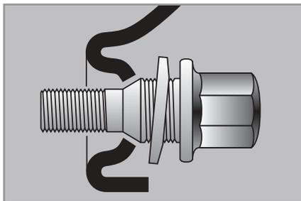
**!** Os parafusos das rodas são específicos para cada tipo de roda. Em caso de troca das rodas originais, verificar com a Rede de concessionárias CITROËN ou em uma oficina qualificada, da compatibilidade dos parafusos com as novas rodas.
