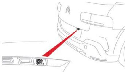
Uma câmera traseira é ativada automaticamente ao engrenar a marcha a ré. A imagem colorida é mostrada na tela de navegação.
