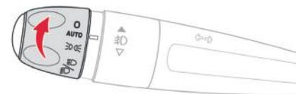
Através de um sensor de luminosidade, em caso de detecção de uma luminosidade externa fraca, as luzes da placa, de posição e faróis baixos, acendem automaticamente, sem ação do condutor. Podem acender em caso de detecção de chuva, em simultâneo com o funcionamento automático dos limpavidros dianteiros.
