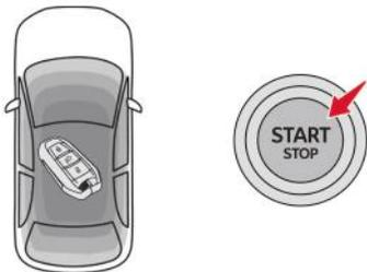
Com a chave eletrônica de acesso e partida mãos livres no interior do veículo, a pressionar o botão "START/STOP", **sem nenhuma ação nos pedais**, permite ligar a ignição.
