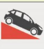
**Na descida em ponto morto** - Deixe o veículo sempre com uma marcha engatada e libere o acelerador quando em declives. Isto fará com que o sistema de injeção corte o combustível. Deixar o carro em ponto morto (**N** nas caixas automáticas) em descidas não garante economia de combustível.
