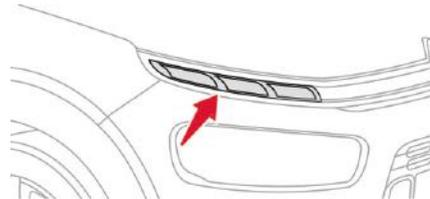
Os díodos eletroluminescentes (LED) acendem-se automaticamente após a partida do motor.
