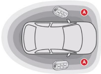
Este sistema permite o destravamento, o travamento e a partida do veículo tendo a chave eletrônica na zona de reconhecimento "A".
