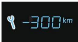
Alguns segundos após ter ligado a ignição, o odômetro total retoma o seu funcionamento normal. **A chave permanece sempre acesa.**
