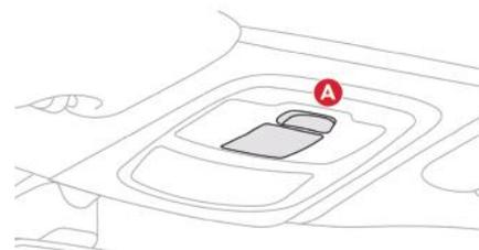
Desencaixe a tampa da luz de teto **A** com uma chave de parafusos fina, do lado do comando, para acessar a lâmpada com defeito.
