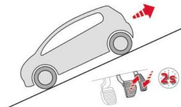
**Em descidas, com o veículo imobilizado e marcha a ré engrenada, este é mantido durante um curto período de tempo, durante a libertação do pedal de freio.**
