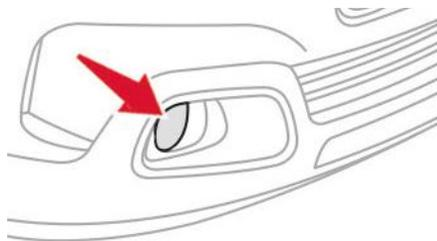
Com os faróis baixos ou altos ligados, esta função permite que o feixe da luz de neblina dianteira ilumine o interior da curva, quando a velocidade do veículo for inferior a 40 km/h (condução urbana, estrada perigosa, cruzamento, manobras de estacionamento...).
