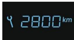
Alguns segundos após ter ligado a ignição, a **chave apaga-se**; o odômetro total retoma o seu funcionamento normal. A tela indica então as quilometragens totais e diária.
