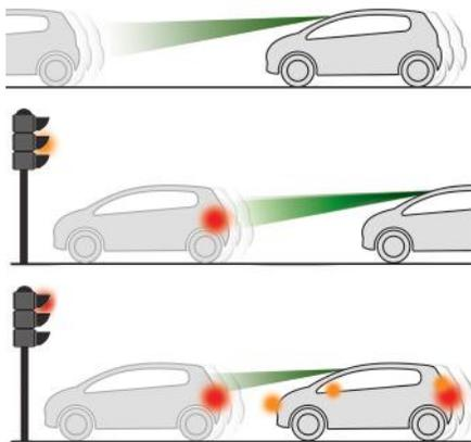
Esta função, também denominada frenagem automática de emergência, tem como objetivo reduzir a velocidade de impacto ou evitar a colisão frontal do seu veículo em caso de ausência de intervenção do condutor.
