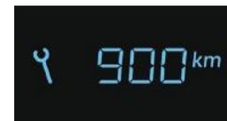
Alguns segundos após ter ligado a ignição, o odômetro total retoma o seu funcionamento normal. **A chave permanece acesa** para lhe assinalar que uma revisão deverá ser efetuada em breve.
