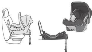
É instalada "de costas para a estrada" através de uma base ISOFIX que é fixa nas argolas **A**. A base inclui um suporte, regulável em altura, que assenta na superfície inferior do veículo. Esta cadeira pode ser fixa através de um cinto de segurança. Neste caso, apenas a estrutura é utilizada e fixa ao banco do veículo através do cinto de segurança de três pontos.
