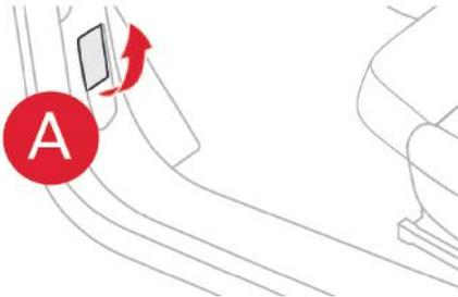
**i** A implantação do comando interior impede qualquer abertura, enquanto a porta esquerda dianteira se encontrar fechada.
