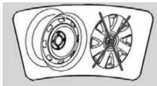
A calota\* é de uso específico das rodas originais do veículo e é proibida a sua montagem na roda sobressalente de uso temporário (estepe).
