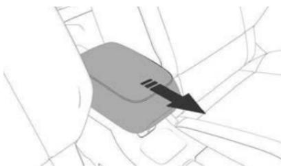
Para o avançar, deslize o apoio de braços até a posição desejada. O apoio de braços desliza até o batente para a frente.
