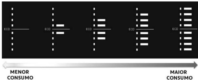
O econômetro é um indicador de consumo de combustível, cuja função é auxiliar o motorista a conduzir o veículo, de maneira mais econômica possível quanto ao consumo de combustível, levando em conta as condições de tráfego e do percurso.
