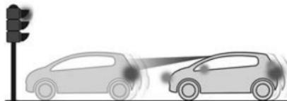
Esta função, também denominada frenagem automática de emergência, tem como objetivo reduzir a velocidade de impacto ou evitar a colisão frontal do seu veículo em caso de ausência de intervenção do condutor.
