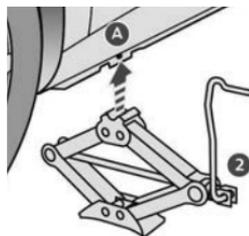
Colocar o macaco 2 em contato com um dos dois lugares dianteiros A ou traseiros B previstos na parte inferior da carroceria, o mais próximo possível da roda que será trocada.
