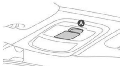
Desencaixe a tampa da luz de teto A com uma chave de parafusos fina, do lado do comando, para acessar a lâmpada com defeito.
