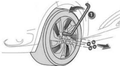
Se o seu veículo tiver rodas de aço, retire antes a calota da roda com a chave de rodas 1 puxando no entalhe da passagem da válvula.
