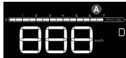
**!** Ao aproximar-se do limite máximo de rotações **A**, o sistema de injeção eletrônica corta o fluxo de combustível para proteção do motor. Este corte de combustível ocasiona perda de potência do motor.
