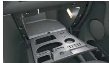
Desencaixe a tampa com uma chave de parafusos fina, para acessar à lâmpada com defeito.
