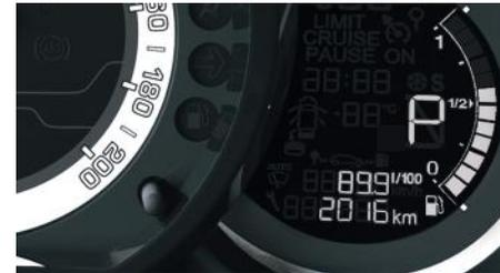
Quando deslocar a alavanca na grelha para selecionar uma posição, acende o respectivo indicador no visor do painel de instrumentos.
