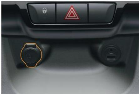
☞ Para utilizar a tomada de 12 V (potência máxima: 100 Watts), retire o obturador e ligue o acessório, é necessário que a chave esteja na posição de acessório.
