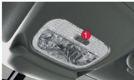
Desencaixe a tampa da luz de teto **1** com uma chave de parafusos fina, para acessar a lâmpada com defeito.
