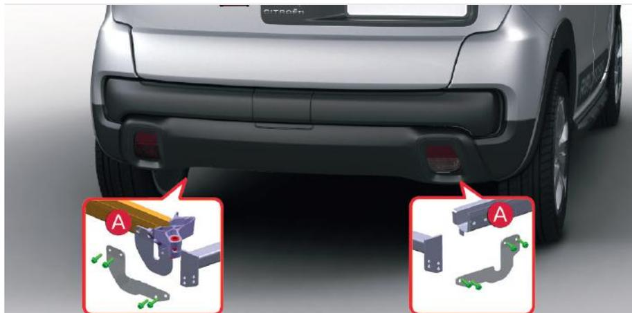
Existem pontos **A** indicados são pré-determinados para a fixação do engate nas longarinas traseiras.
