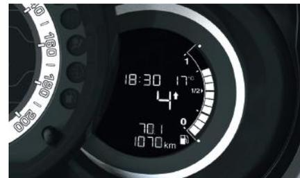
**i** O sistema adapta as instruções de alteração de marcha em função das condições do deslocamento (inclinação da via, carga,...) e das solicitações do condutor (solicitação de potência, aceleração, frenagem,...).
