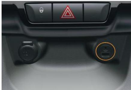
Caixa de ligação, composta por uma porta USB e encontra-se situada no porta objetos inferior. Permite ligar um equipamento portátil, tal como um equipamento portátil digital tipo iPod® ou um pen drive USB.
