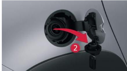
2. Abertura e fixação da tampa do reservatório.
