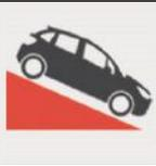
**Na descida em ponto morto** - Deixe o veículo sempre com uma marcha engatada e libere o acelerador quando em declives. Isto fará com que o sistema de injeção corte o combustível. Deixar o carro em ponto morto (**N** nas caixas automáticas) em descidas não garante economia de combustível.
